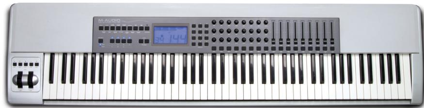
将 Keystation Pro 88 设为使用“预设 7”。键盘左边的调制和音高滑音轮上方的走带按钮，映射到“走带”窗口上的相应功能。LCD 显示屏右边键盘上的按钮 9 可隐藏和显示“混音器”窗口。默认情况下，键盘上方的首八个推子映射到混音器中的推子，用于首八个谱表，但您可以通过发出程序 2 的程序变更，切换它们以控制虚拟乐器输出。第九个推子永远映射到主音量控制。推子下方的按钮可以使相应谱表或虚拟乐器独奏。推子左边的旋转控制钮底行，可控制首八个谱表的声像设置；中间行可控制谱表 9-16 的声像。
