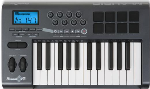
将 Axiom 25 设为其默认程序。键盘上方的八个旋钮映射到混音器中的推子，用于乐谱中的首八个谱表；LCD 显示屏下方的走带按钮则映射到“走带”窗口上的相应功能。
