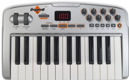
将Oxygen 8设为其默认音色。键盘上方的旋转控制钮，映射到混音器中的推子，用于首八个谱表。旋转控制钮下方的走带按钮则映射到“走带”窗口上的相应功能。
