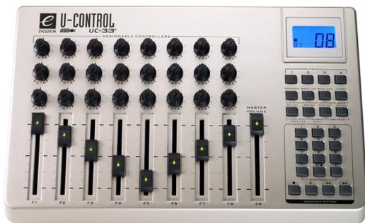
将 UC-33 设为其默认音色。默认情况下，首八个推子映射到混音器中的推子，用于首八个谱表，但您可以通过发出音色 2 的音色变更，切换它们以控制虚拟乐器输出（发出音色 1 的音色变更可切换回控制谱表音量）。第九个推子永远映射到主音量控制。推子右边编号 1-8 的按钮可以使相应谱表或虚拟乐器独奏。推子上方底行的旋转控制钮，可控制首八个谱表的声像设置。中间行可控制谱表 9-16 的音量设置，而顶行可控制谱表 9-16 的声像设置。界面右下角的走带按钮则映射到“走带”窗口上的相应功能。
