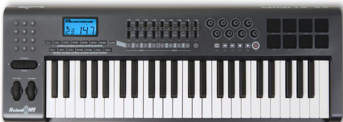
将 Axiom 49 或 Axiom 61 设为其默认程序。默认情况下，键盘上方的首八个推子映射到混音器中的推子，用于首八个谱表，但您可以通过发出程序 2 的程序变更，切换它们以控制虚拟乐器输出。第九个推子永远映射到主音量控制。推子下方的按钮可以使相应谱表或虚拟乐器独奏。推子右边的旋转控制钮，可控制混音器中首八个谱表的声像。LCD 显示屏下方的走带按钮则映射到“走带”窗口上的相应功能。
