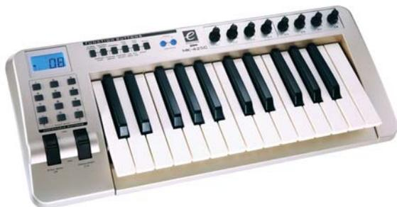
MK-425c を標準設定のプログラムに設定します。キーボードの上にある 8 つのロータリーコントロールは [ミキサー] の最初の 8 つの譜表のボリュームを調整し、キーボードの左側にある 1 ~ 8 までの番号が付いたボタンは、対応する譜表をそれぞれ調整します。
