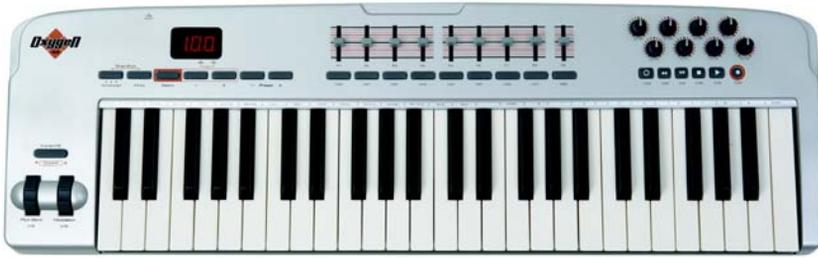
Oxygen 49 または Oxygen 61 を標準設定のプログラムに設定します。標準設定では、キーボードの上にある最初の 8 つのフェーダーは最初の 8 つの譜表用に使う **【ミキサー】** のフェーダーに割り当てられますが、「プログラム 2」にプログラム変更すると、バーチャルインストゥルメントの出力フェーダーを調整するように切り替えることができます（「プログラム 1」にプログラム変更すると、譜表のボリューム調整に再度切り替えが可能）。9 番目のフェーダーは常にマスターボリュームコントロールに割り当てられます。フェーダーの下のボタンは対応する譜表またはバーチャルインストゥルメントをソロにします。フェーダーコントロールの右側にあるロータリーコントロールは最初の 8 つの譜表のパンの位置を調整します。ロータリーコントロールの下にあるトランスポートボタンは **【再生】** ウィンドウの対応する機能に割り当てられます。
