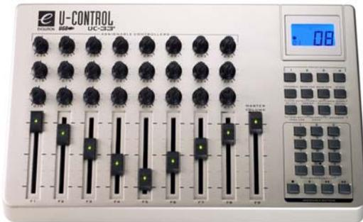
UC-33e を標準設定のプログラムに設定します。標準設定では、最初の 8 つのフェーダーは最初の 8 つの譜表用に使う **【ミキサー】** のフェーダーに割り当てられますが、「プログラム 2」にプログラム変更すると、バーチャルインストゥルメントの出力フェーダーを調整するように切り替えることができます（「プログラム 1」にプログラム変更すると、譜表のボリューム調整に再度切り替えが可能）。9 番目のフェーダーは常にマスターボリュームコントロールに割り当てられます。フェーダーの右側にある 1 ~ 8 までの番号が付いたボタンは、対応する譜表またはバーチャルインストゥルメントをソロスティックに用います。フェーダーの上にあるロータリーコントロールの最下列は最初の 8 つの譜表のパンの位置を調整します。中間列は 9 ~ 16 の譜表のパン設定を調整します。サーフェイスの右下隅にあるトランスポートボタンは、**【再生】** ウィンドウの対応する機能に割り当てられます。
