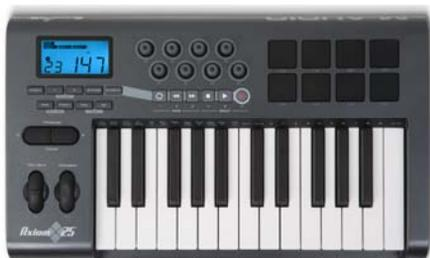
Axiom 25 を標準設定のプログラムに設定します。キーボードの上にある 8 つのノブはスコア内の最初の 8 つの譜表の【ミキサー】のフェーダーに割り当てられます。LCD 画面下のトランスポートボタンは【再生】ウィンドウの対応する機能に割り当てられます。
