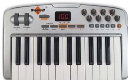
Oxygen 8 v2 を標準設定のプログラムに設定します。キーボードの上にあるロータリーコントロールは最初の 8 つの譜表用に使う [ミキサー] のフェーダーに割り当てられます。ロータリーコントロールの下にあるトランスポートボタンは [再生] ウィンドウの対応する機能に割り当てられます。
